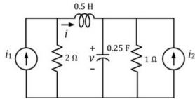
$$\frac{d}{dt} \begin{bmatrix} v \\ i \end{bmatrix} = \begin{bmatrix} -4 & 4 \\ -2 & -4 \end{bmatrix} \begin{bmatrix} v \\ i \end{bmatrix} + \begin{bmatrix} 0 & 4 \\ 4 & 0 \end{bmatrix} \begin{bmatrix} i_1 \\ i_2 \end{bmatrix}$$
